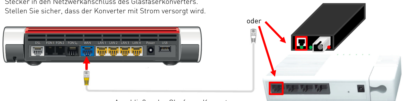
Anschließen des Glasfaser-Konverters
