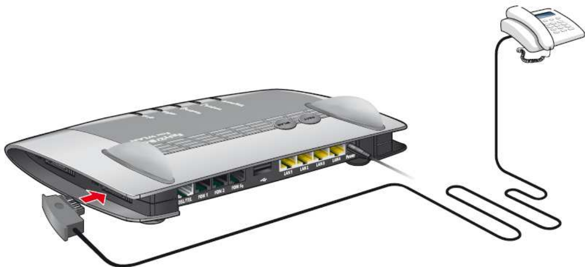
Anschluss eines Telefons mit TAE-Stecker
